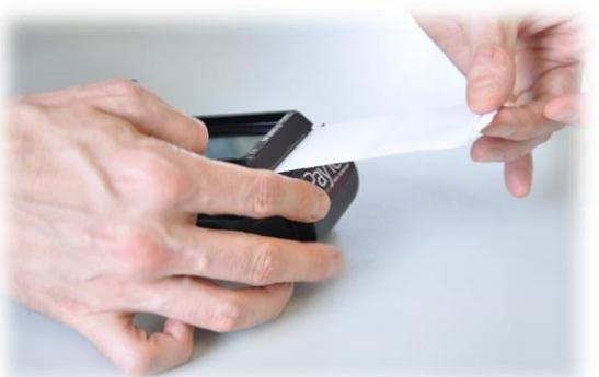
Le couvercle de l'imprimante peut maintenant être refermé. Il est important qu'un bout du rouleau de papier sorte déjà de l'appareil.
