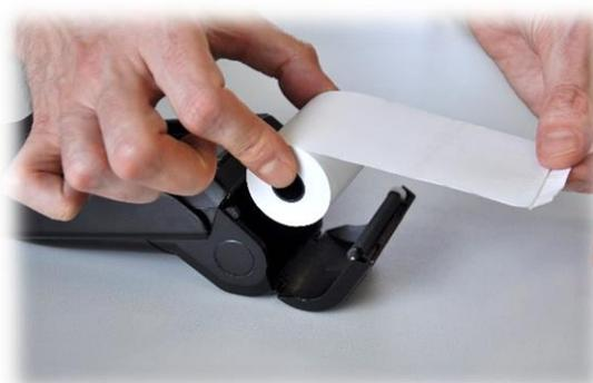
Les restes de l'ancien rouleau de papier doivent être entièrement retirés et un nouveau rouleau de papier doit être inséré. Assurez-vous d'insérer le rouleau de papier comme illustré, sinon l'imprimante ne fonctionnera pas. Déroulez le rouleau de papier un peu avant de l'insérer.
