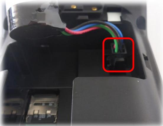
6. In diesem Zustand kann der Akku montiert werden.
