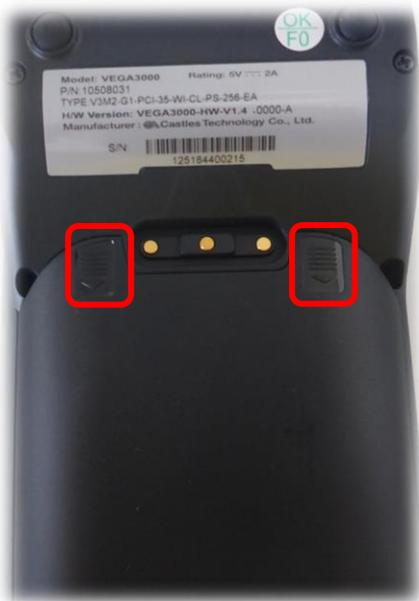
3. Nach dem Lösen der Schnappverschlüsse kann der Deckel abgehoben werden.
