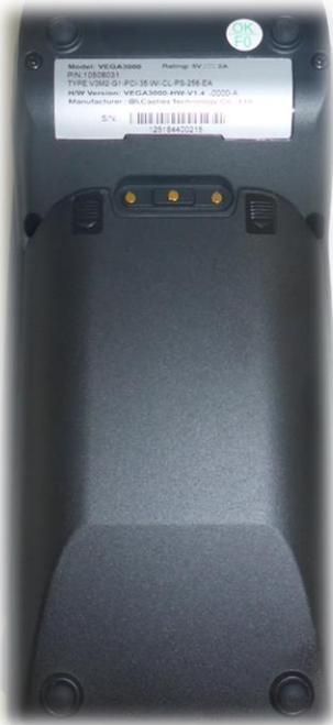
2. Als nächstes wird der Deckel vom Gerät entfernt. Dabei müssen die Schnappverschlüsse ganz einfach mit beiden Händen nach unten geschoben werden.
