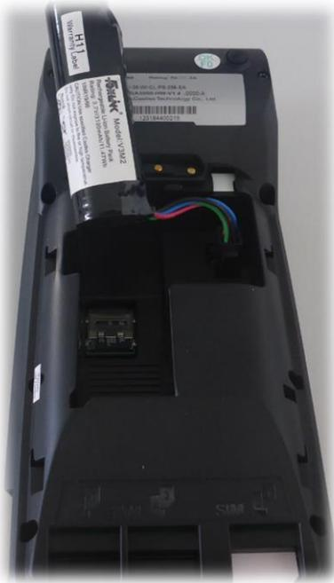
5. Als nächstes muss der Akku sorgfältig und gleichmässig gelockert werden. Die schwarze Stiftleiste muss dabei gedrückt werden, damit der Akku ausgesteckt werden kann.
