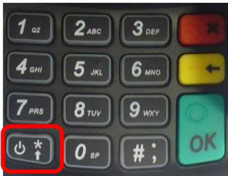
2. Sobald die Einschalt- bzw. Ausschalttaste gedrückt wurde, erscheint eine Auswahl von Optionen welche ausgeführt werden können. Bei dieser Auswahl muss die 3 Variante (3: Ausschalten) ausgewählt werden, um diese Auswahl anzuwählen müssen Sie die Taste 3 (3DEF) drücken.
