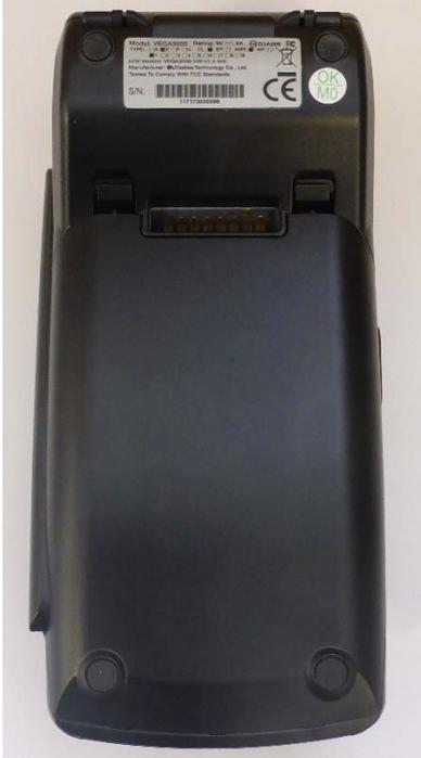
2. Als nächstes wird der Deckel vom Gerät entfernt, dabei werden die beiden Schnappverschlüsse gelöst. Dabei müssen Sie mit dem Fingernagel oder einer Pinzette von oben einfahren und die beiden Schnappverschlüsse anheben.
