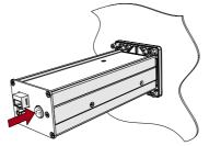
Das Verbindungskabel wird mit dem PSI-Modul verbunden. Das PSI-Modul sollte zu diesem Zeitpunkt noch nicht gespeist sein.
