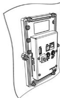
Anschließend wird das PayTec V2 mit den Muttern verschraubt.
