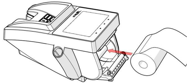
Die Reste der alten Papierrolle werden vollständig entfernt und eine neue Papierrolle eingesetzt. Achten Sie darauf, dass Sie die Papierrolle wie auf dem Bild einlegen, da die Papierrolle nur einseitig bedruckbar ist. Wickeln Sie die Papierrolle ein bisschen ab, bevor Sie diese einlegen.
