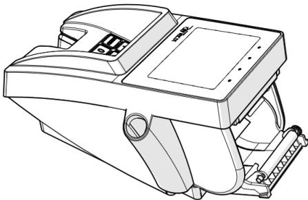
Der Druckerdeckel wird mit der Klappe vorsichtig geöffnet.
