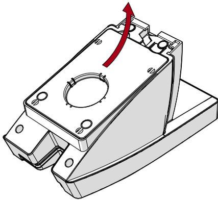
Die Bodenabdeckung wird leicht nach oben geschoben und danach entfernt. Hierfür muss lediglich der obere Teil rechts eingedrückt werden, damit der Deckel abfällt.
