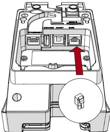
Am Ende wird das Stromkabel verbunden. Das Netzteil wird wie oben abgebildet angehängt
