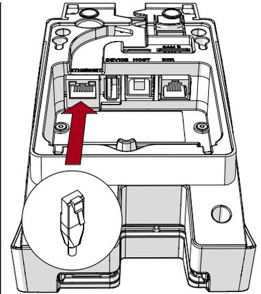
Je nach Konfiguration des Terminals (siehe Kapitel 7 Konfigurationsarten) wird das Netzkabel eingesteckt.
