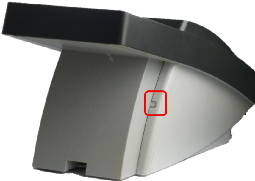
Der oben markierte Resetknopf unterhalb des Bildschirms dient dazu das Terminal neuzustarten. Hierfür muss wie folgt vorgegangen werden:
