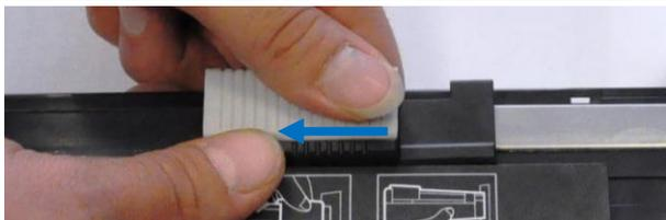
Der schwarze Schieber wird mit dem Daumen fixiert, der weisse Schieber wird auf die gleiche Höhe zurückgezogen.
