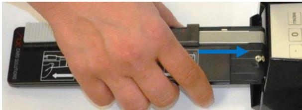
Das Kartenevakuierungstool wird bis zum Anschlag in das Terminal gesteckt.
