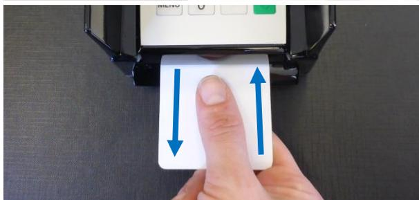
Die Reinigungskarte wird eingeführt und wieder herausgezogen. Dieser Vorgang wird drei bis vier Mal wiederholt.
